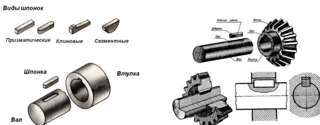
Рисунок 2 – Виды шпонок, шпоночное соединение
